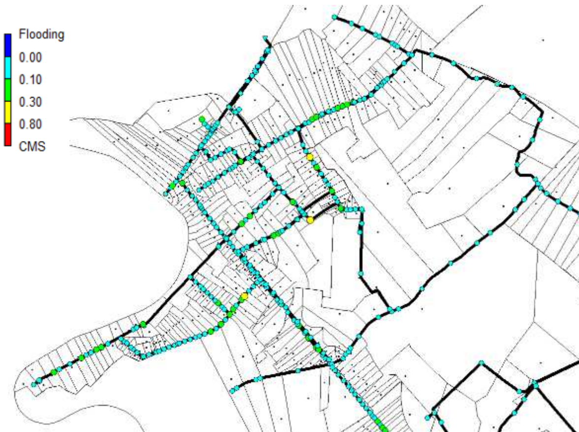
Figura 47: Planimetria del modello della rete allo stato di fatto – involucro dei massimi – Tr50 anni, durata 1 ora
